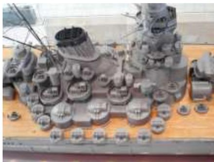
「集中防御方式」 主要部分を艦の中心に集め、中央部分の防衛を強化
