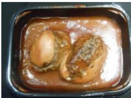
トレイは溶けていないが、トップシールの残りが溶けている
