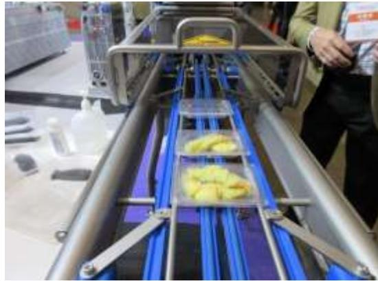
MAP 包装機 上蓋をずらして置けば自動的にMAP包装して蓋をする仕組み
