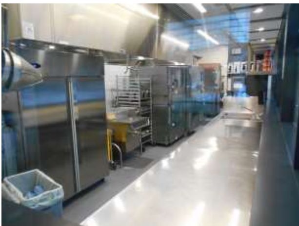
機械化された衛生的なキッチン 道路からガラス越しに外から作業が見えるようになっている。加熱釜とスチームコンベクション2台、オーブンの隣にチラー2台。製造した商品を常温で販売することはない
