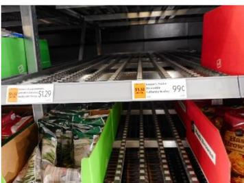
冷凍食品もバックヤードの冷凍庫と直結。棚板にローラーがついているため、裏から段ボールごとスライドさせる府だけで陳列できる。段ボールの側面が仕切り版の役割を果たしている。
