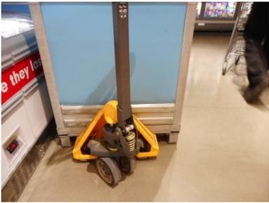
専用コンテナにはキャスターが付いていない。重量が重いため、床を気づ付けるのを防ぐためだ。パレットキャリアーで売場まで運ばれる。
